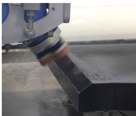
Polissage de chant incliné avec tête à satellites AR-3
