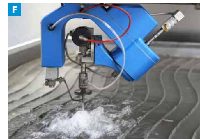
EN 5-axis head (X, Y, Z, A, C)
