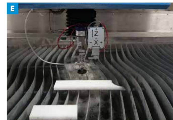
EN 3-axis head (X, Y, Z)
