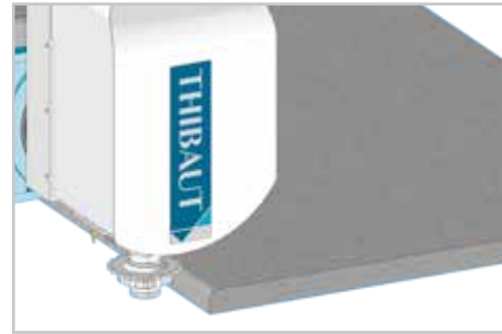
Profilage/polissage par meule de forme.
