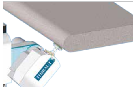
Mise en forme d'un profil par meule Ø130 mm.
