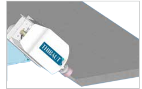
Polissage d'arête horizontale.
