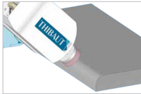
Mise en forme et polissage par meule Ø130 mm.
