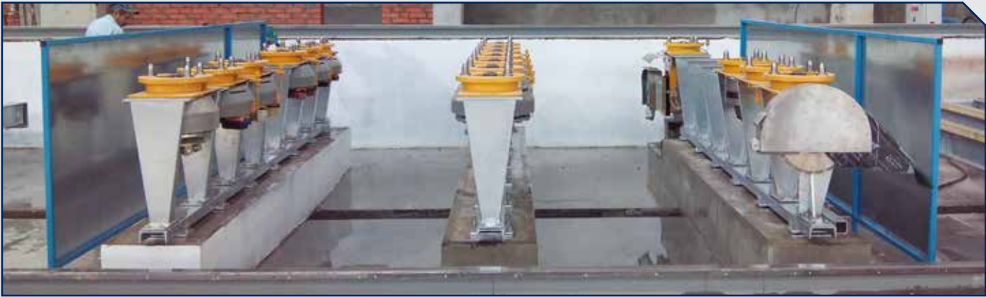
▶ Tool magazine : central (for pendular work) or at left/right end side. Tool magazine up to 4 rows. ▶ Magasin d'outils : central (pour travail en pendulaire) ou aux extrémités. Magasin d'outils jusqu'à 4 rangées. ▶ Position des Werkzeugmagazin ist mittig oder seitlich am Maschinenanfang oder Ende platziert. Werkzeugmagazin mit 1 bis 4 Reihen. ▶ Инструментальный магазин: центральный (для маятниковой обработки) или на концах Инструментальный магазин до 4 рядов
